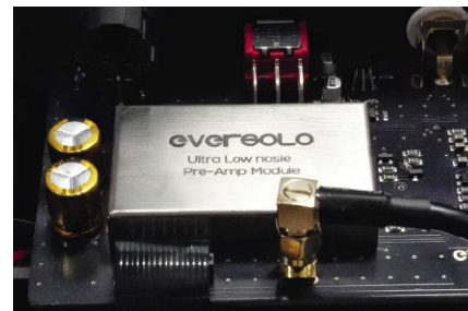
W metalowych osłonach zamknięto niskoszumowe wzmacniacze "Pre-Amp Module".
